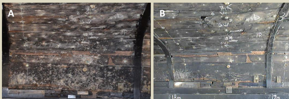
Area selezionata per il campione pilota di pulitura (A); confronto con la condizione in cui versava subito dopo l'intervento di restauro condotto dall'archeologa H. Frost (B)
