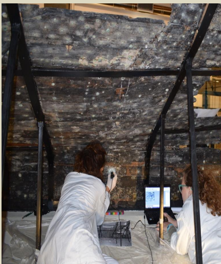
Primo esame conoscitivo della superficie lignea con microscopio a contatto; macro stato coerenza fisico-meccanica della superficie lignea
