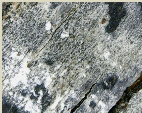
Primo esame conoscitivo della superficie lignea con microscopio a contatto; macro stato coerenza fisico-meccanica della superficie lignea
