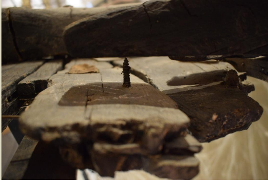
Evidente imbarcamento di un madiere e distacco dalla vite di restauro
